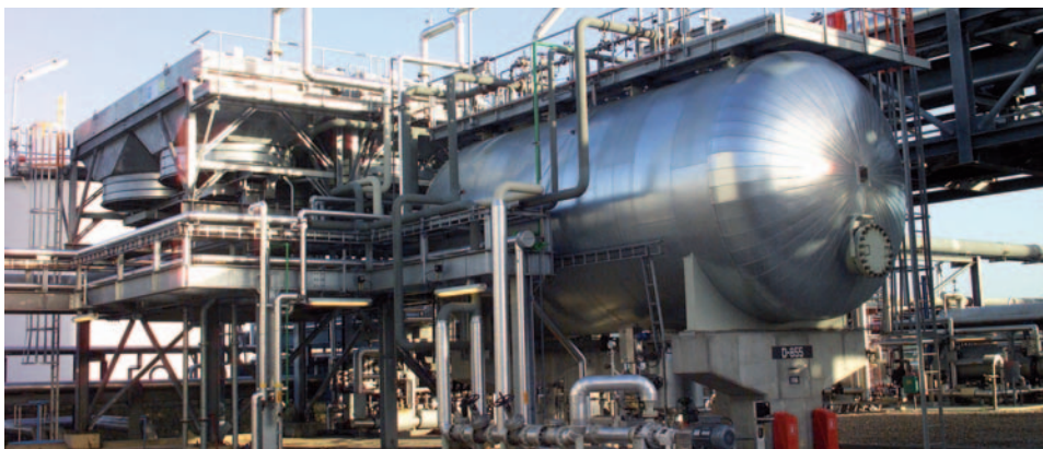
Gasolietørrer sat i drift i forbindelse med GF3 projekt.
