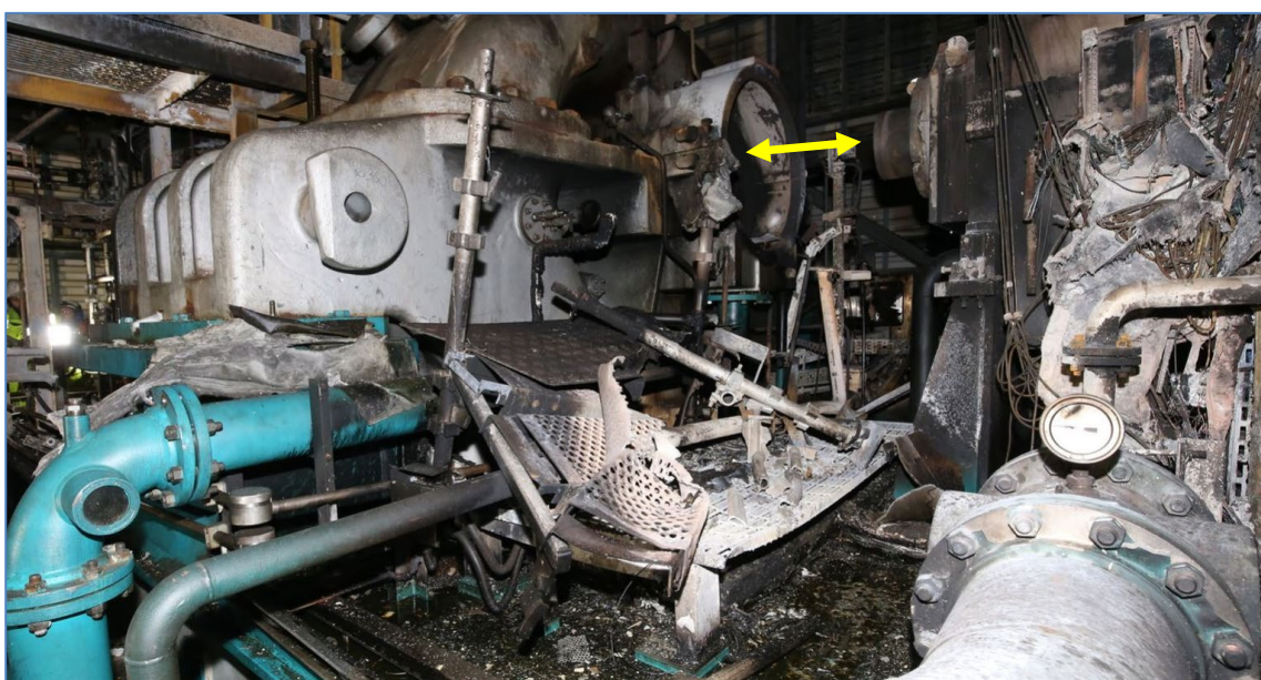
Figur 1-1 Turbingeneratoren etter brannen.
