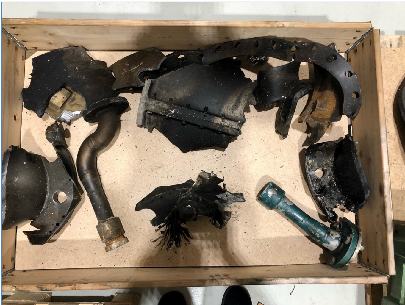
Figur 6-11 Noen av delene som er samlet opp etter koblingshavariet. Kassen måler 120 cm x 80 cm. Delen nederst, midt i bildet veier 10,7 kg
