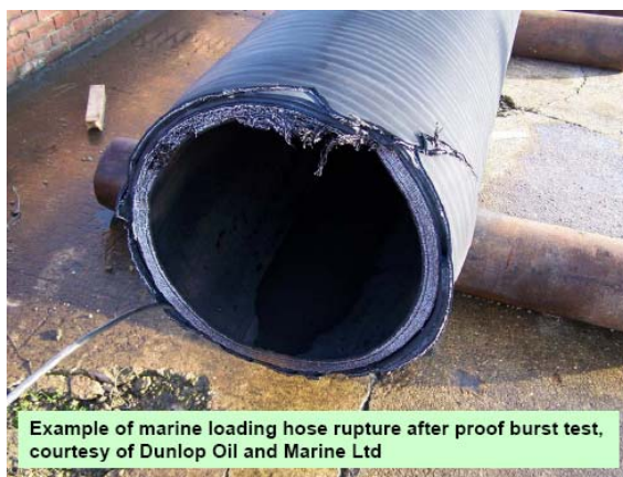
Bilde 7.2 Bilde fra "burst-trykk" test hos produsent (venstre) og OLS A lasteslange (høyre).
