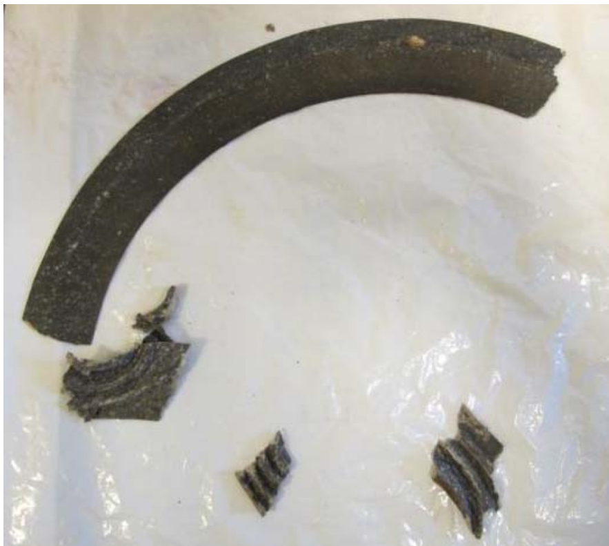
Bilde 1.1.1. Resterende pakning etter gasslekkasjen, pakningsmaterial var av fibertype Foto: Statoil
