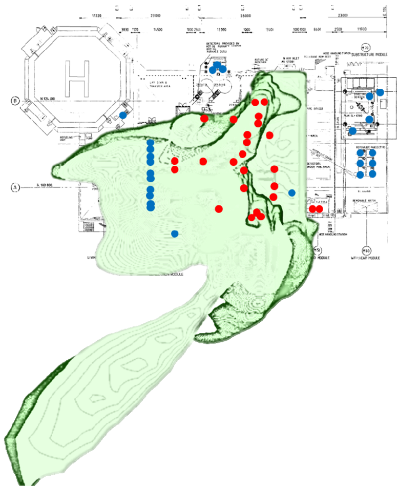
Figur 10. Plassering av gassdetektorer på værdekk, sammenlignet med simulert gassky, her vist som 20 %LEL ved 230s. PS! Gasskyen er projisert ned på værdekk.
